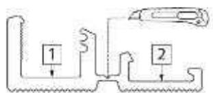
**Пластиковая направляющая** также состоит из двух частей. Разъедините их, вырезав выемку ножом.
