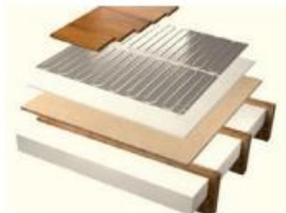
4d. Электрический теплый пол – при укладке ламината мы не рекомендуем использовать данный тип теплого пола вместе с сухой стяжкой.
